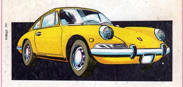
ESTE MODELO DE LA AFAMADA MARCA ALEMANA POSEE UN MOTOR DE 1991 CC., QUE LE DA UNA POTENCIA DE 148 HP. SU VELOCIDAD MÁXIMA ES DE 117 MILLAS POR HORA, POSEE UNA CAJA DE CAMBIOS MANUAL DE CUATRO VELOCIDADES MÁS LA RETROMARCHA. TODOS LOS CAMBIOS SON SINCRONIZADOS.
